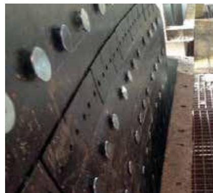
Borracha de desgaste resistente à graxa e óleo (NBR) substituível encaixada na parte interna da cunha de alumínio do MAXI-ULTRA por parafusos tipo Allen.
